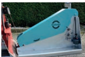
2390277 Schmid RopoCheck100 Vorführgerät, mobiler Seilwindenprüfstand, mit Software für graphische Auswertung, info@schmid-waldstetten.de, GBRM geschützt+Patent angemeldet
